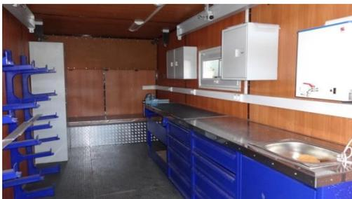
Данное помещение представляет собой контейнер типа 1СС с установленными внутри контейнера стеллажом, верстаком, столом. Габариты контейнера уменьшены для возможности его транспортировки на шасси автомобилей высокой проходимости. В состав оборудования могут входить
