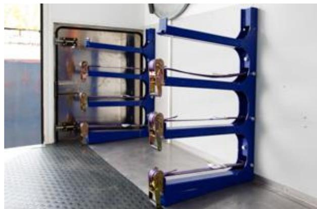
Стены обшиты рифленой сталью толщиной 1,5 мм и окрашены на грунтровку высококачественной автомобильной эмалью с соблюдением всех технологических требований.
