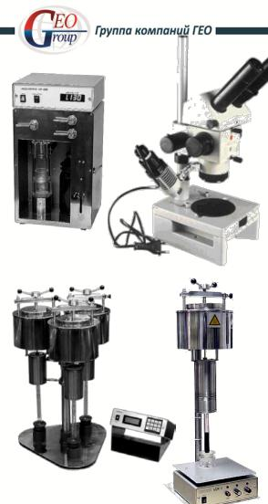
Геологический модуль станции ГТИ представляет комплекс геологических приборов и технических средств, обеспечивающих изучение свойств горных пород и бурового раствора непосредственно на буровой.
