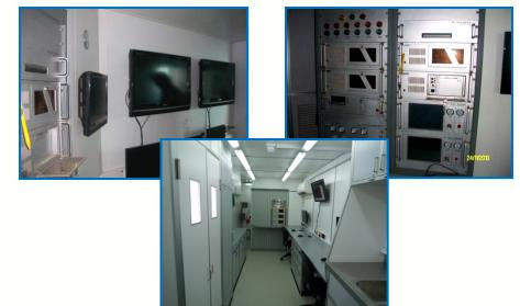
Основной компонент станции ГТИ – Система сбора информации. Наши геологи и инженеры, хорошо обученные на буровых установках, используют мощное и проверенное программное обеспечение для сбора и хранения литологической и технической информации, полученной с датчиков, для комплексной оценки пласта, контроля за процессом бурением и надёжности функционирования.
